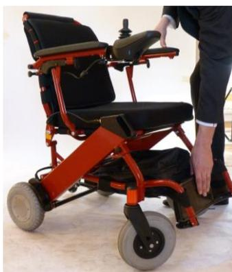
Avec le pied, ou la main, poussez le repose pied vers l'arrière, il va s'escamoter à l'intérieur du fauteuil. Cette action peut être faite par le talon de l'utilisateur
