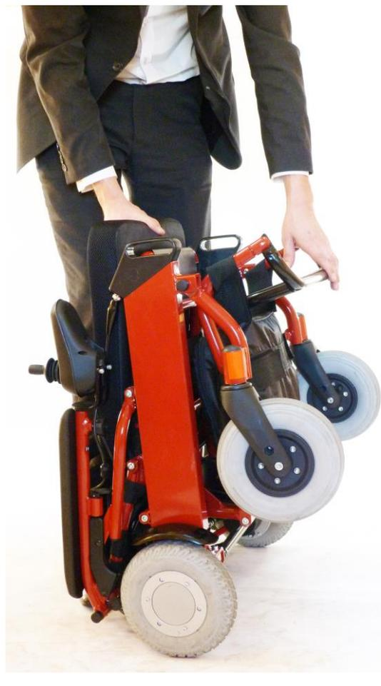
Ramenez la partie inférieure du fauteuil vers l'assise, tout en maintenant le fauteuil à la verticale, positionné sur les roues arrière.
