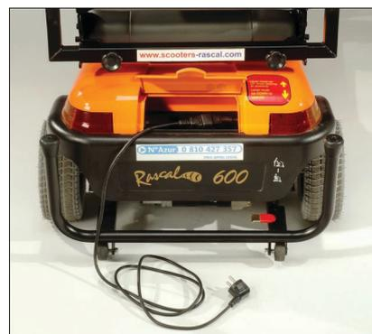
**Chargeur intégré :** une simple prise à dérouler lors des recharges.
